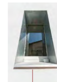
Recuo da janela para uma posição interior e aumento da superfície envidraçada até ao limite do vão. Maximização da luz no interior e a possibilidade colocar objetos como vasos no parapeito pelo exterior. Peitoril da janela permite a colocação de objectos como vasos mas sempre pelo interior. Caixilharia de madeira com grande expressão e área de vidros reduzida.
